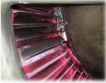
C) REALIZAR AJUSTE Y CALIBRACION DE LOS IGV'S.
